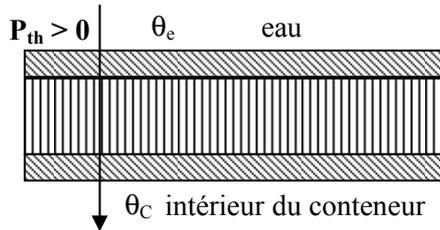
La température  $\theta_e$  de l'eau de mer est supérieure à la température  $\theta_C$  à l'intérieur du conteneur donc un transfert thermique spontané a lieu de l'extérieur vers l'intérieur du conteneur frigorifique.
